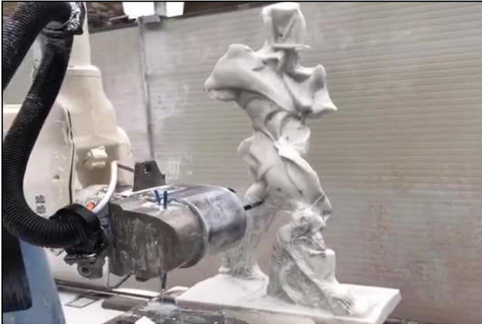
Enrico Dini von D-Shape mit der Firma TorArt: 3D-Fräsung aus Marmor.
