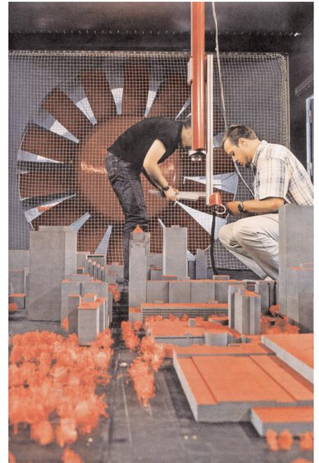
Abb. 22: Verkleinerte Oklahoma City im Windkanal: Meteorologen der Uni Hamburg simulieren die Ausbreitung gefährlicher Gase in Städten.
