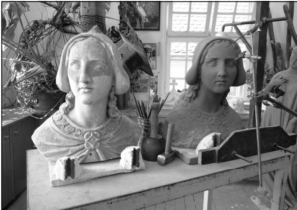
Punktiergerät an einer Kopie einer Figur für das Straßburger Münster.
