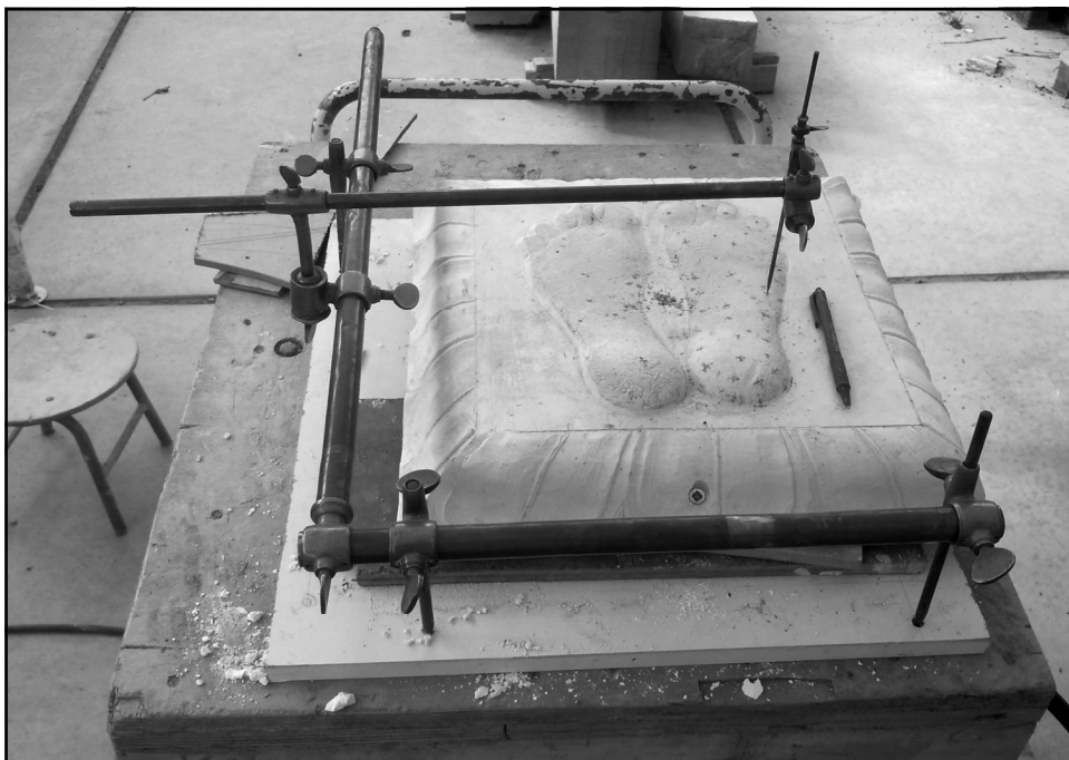
Punktiermaschine und Gipsmodell, 20. Jh.
